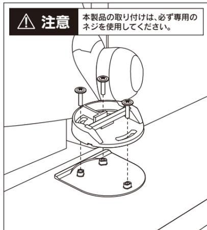
**注意** 本製品の取り付けは、必ず専用のネジを使用してください。
