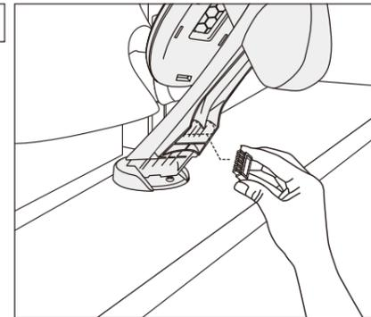
設定はアームユニット裏側に装着されているストッパーの位置を変えるだけで調整できます。
